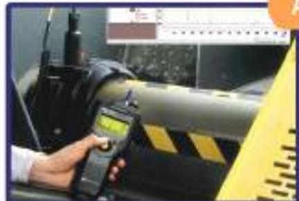
Le principe de l'analyse vibratoire est de rechercher les fréquences propres générées par des contraintes mécaniques dont l'amplitude permet de déterminer la naissance d'une anomalie. Pour cela, on collecte des spectres, représentant tous les phénomènes répétitifs caractérisés par des fréquences et des amplitudes. Cette méthode
