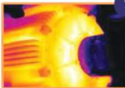
Utiliser la thermographie infrarouge, c'est identifier et évaluer des défaillances éventuelles, parfois plusieurs mois avant qu'elles ne soient apparentes. Cette méthode permet, sur site et sans arrêt des installations, de visualiser les points chauds aussi bien dans les machines tournantes (échauffement anormal d'un roulement...) que dans les armoires électriques (cosse mal serrée, fusible sous dimensionné...).
