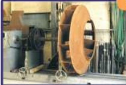
Permet de réaliser la correction à la vitesse nominale de la machine et garantit ainsi un résultat optimum sans démontage et dans un délai très court.
