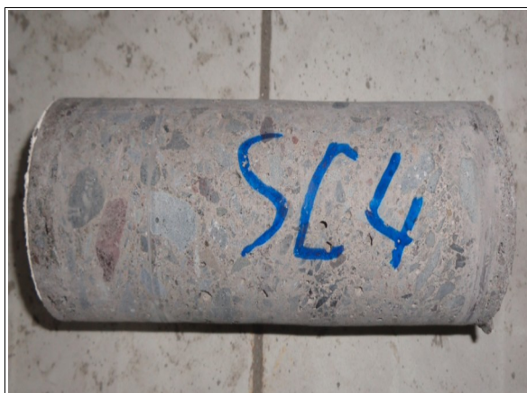
Carotte béton pour essai de résistance à la compression
