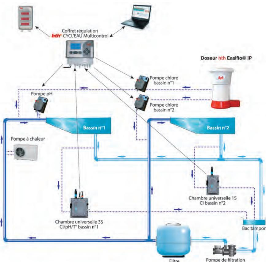
Schéma d'installation régulation ampérométrique
