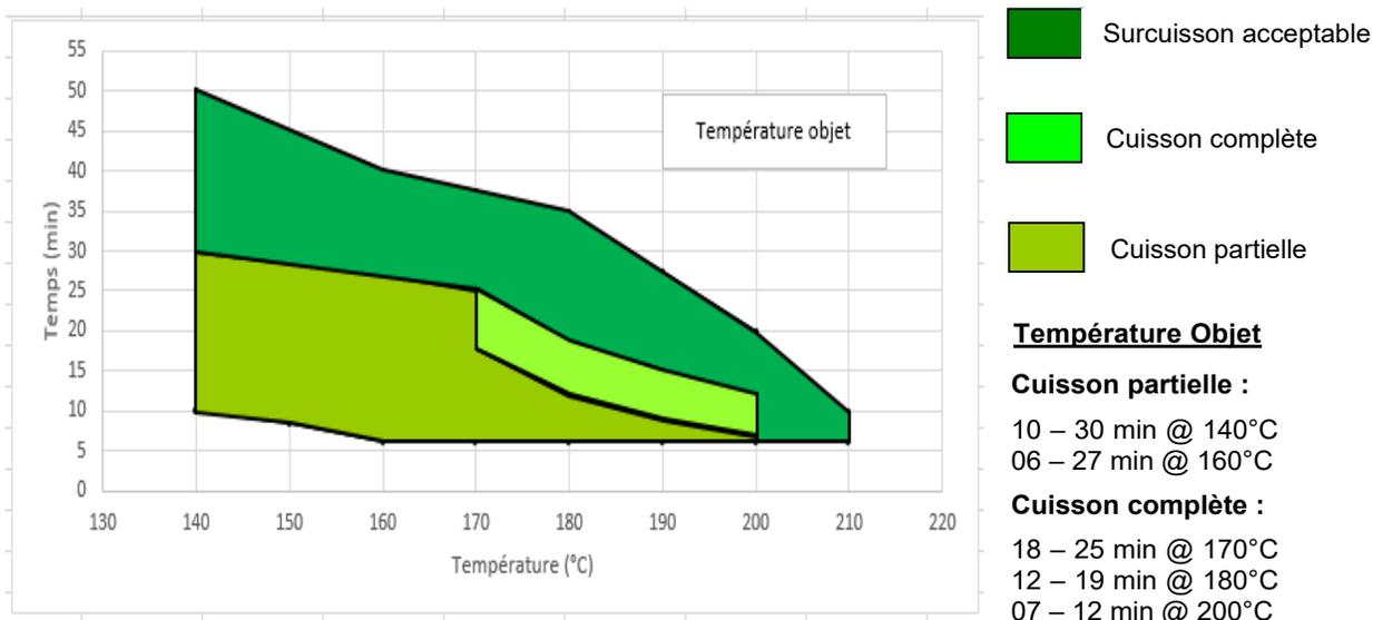
**\*En cas d'utilisation hors abaque, et particulièrement avec un four à flamme directe, nous conseillons de réaliser un test de validation avant la mise en série.**
